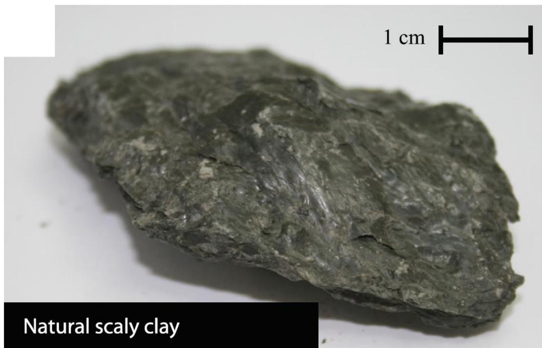
圖 13 泥岩斷層帶中所出現表面光滑且帶有擦痕的鱗片狀泥岩(scaly clay)(照片引用自 Orellana et al., 2018)。
