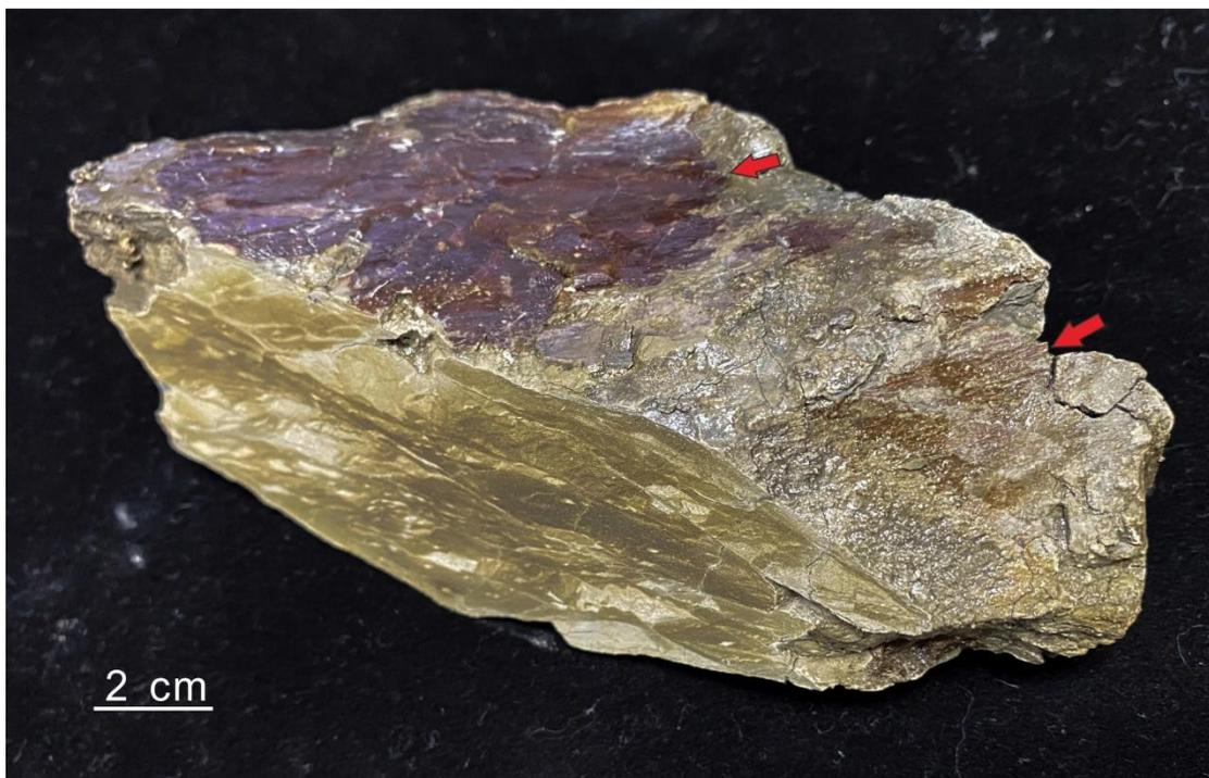
圖 60 黑色破碎泥岩手樣本表面的清晰擦痕。紅色箭頭處指示擦痕位置，因岩石表面已進行上膠保存處理，顏色及反光在紀錄上存在些許差異。
