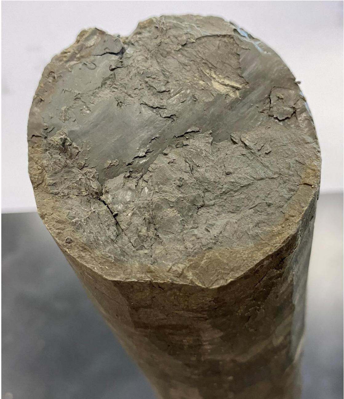
圖 76 岩心截面上所出現的擦痕。擦痕位於岩心 8.3 公尺處且出現於光滑的曲面上。
