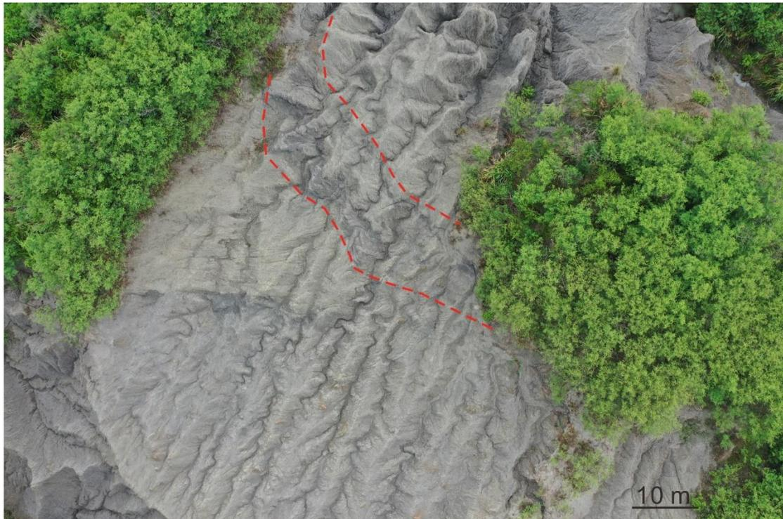
圖 28 車瓜林斷層於半天寮的露頭空照影像。虛線包夾處為露頭上所能觀察到呈現束狀的灰黑色條帶，走向為  $N19^{\circ}W$ 。
