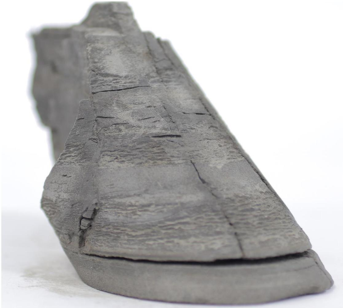
圖 70 完整砂岩近照。岩心中的完整砂岩在清洗過後可觀察到其為砂泥含量不同的砂岩所組成。
