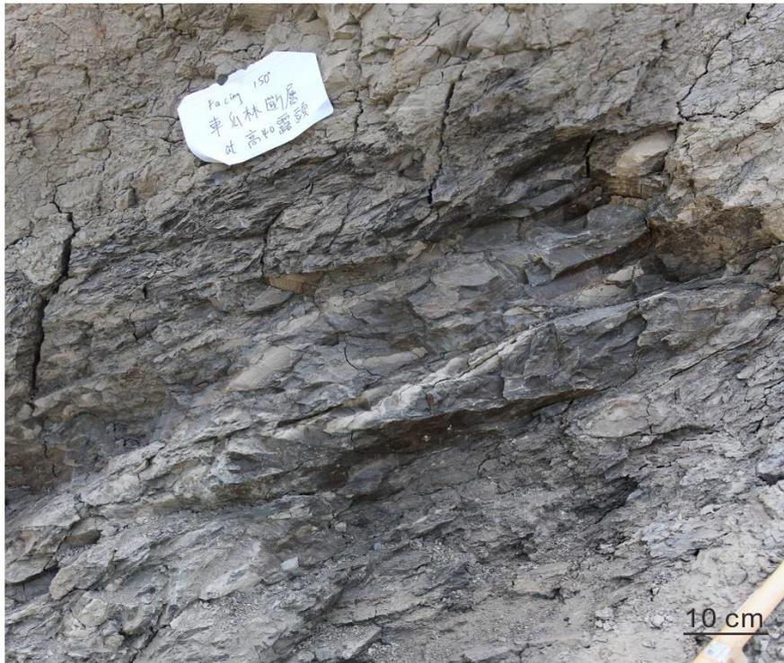
圖 37 斷層帶中呈現鱗片狀的泥岩，其中存在淺色的砂質碎屑。
