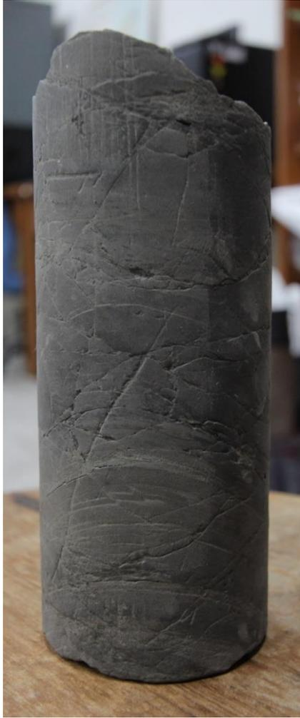
圖 72 破碎砂岩近照。破碎砂岩破裂面發達且不具有特定方向，並可在其中觀察到微型斷層的出現。
